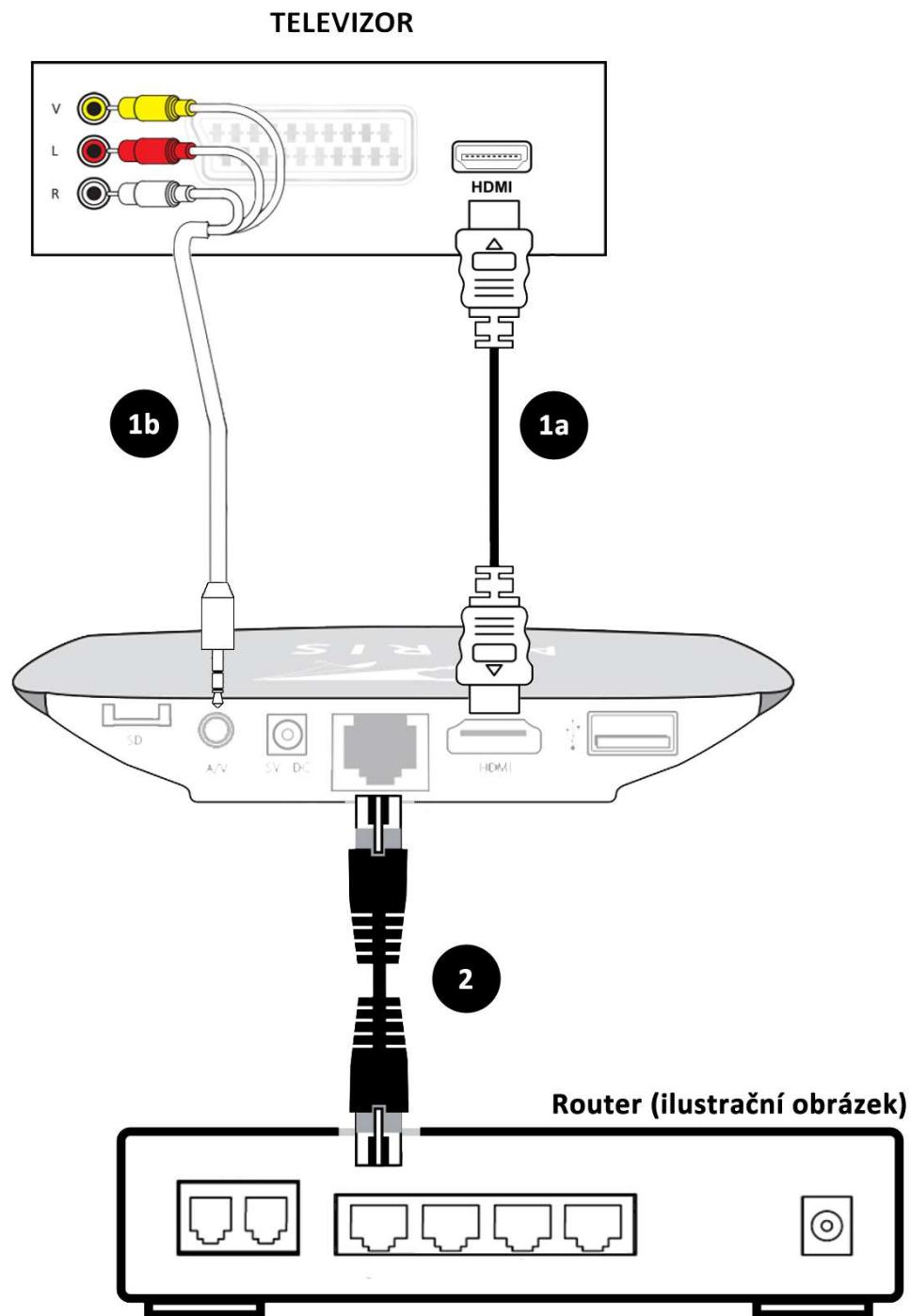
Obr. 3: Schematické znázornenie celkového zapojenia
